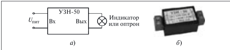
Рис. В4. Схема подключения (а) и внешний вид (б) устройства защиты от наводок 1
